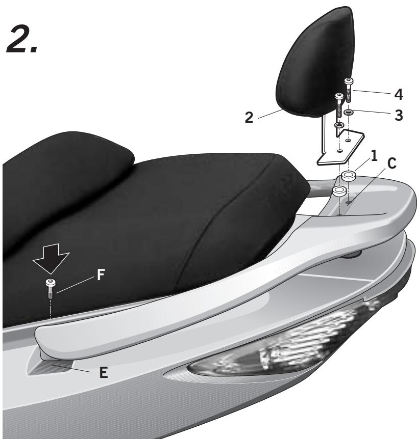
(E) Colocar los distanciadores (1), en zona (C). Montar el KIT RESPALDO (2), en zona (C) mediante los distanciadores (1), las arandelas (3) y los tornillos (4). Volver a apretar en zona (E) los tornillos (F).
