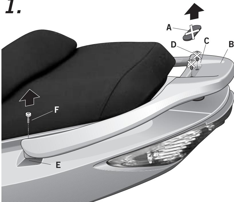
(E) Desmontar y desestimar la tapeta de goma (A) del agarradero trasero (B). Desmontar y desestimar en zona (C) los tornillos (D) y aflojar en zona (E) los tornillos (F).
